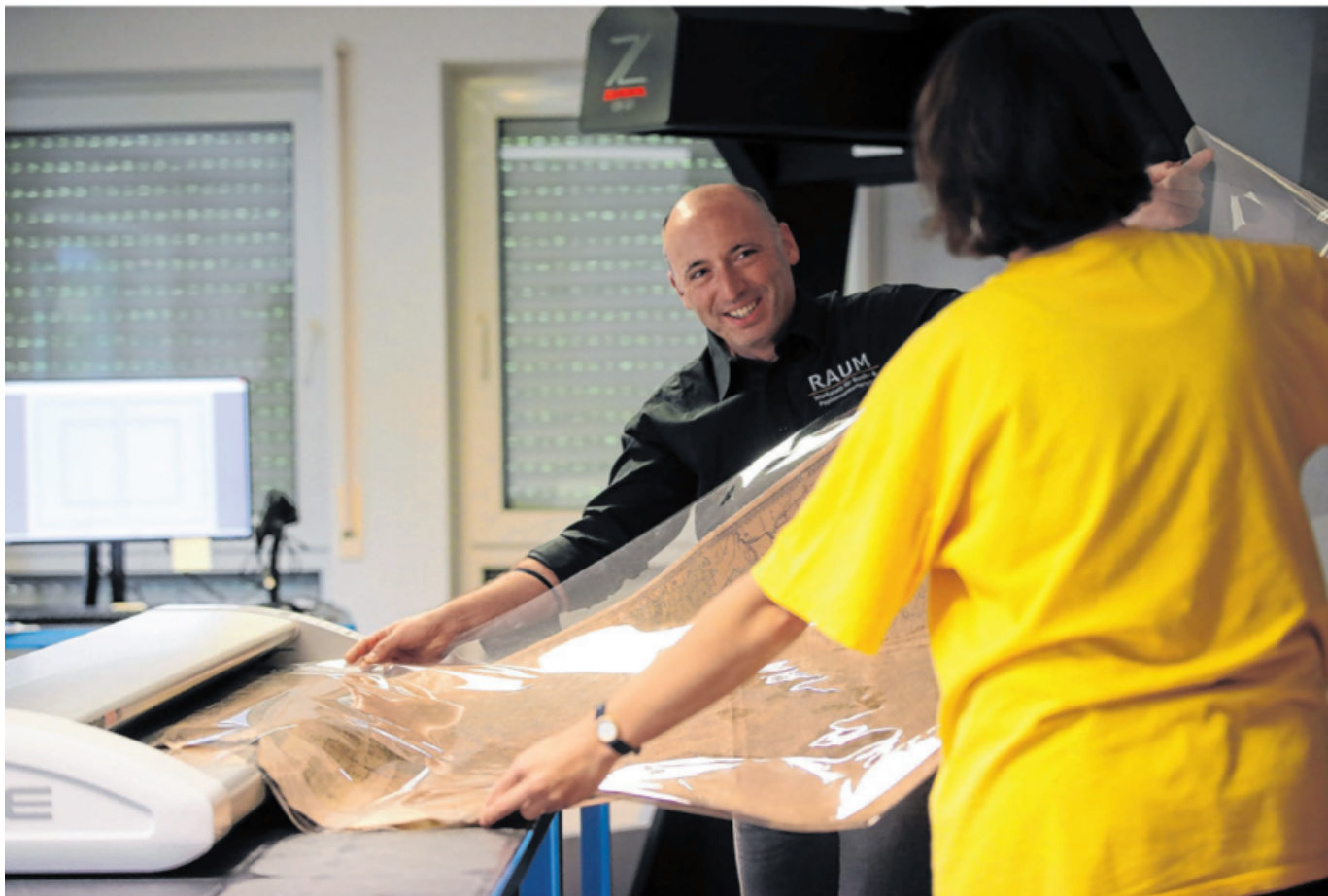
In Matthias Raums Werkstatt befindet sich unter anderem der größte Durchlaufscanner, den es auf dem Markt für Profis gibt. Maximal 152 Zentimeter breite Dokumente können in endloser Länge durch das Gerät laufen. Damit nichts verknittert, hat er passende Folientaschen gebastelt.
